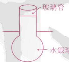
玻璃管先遇熱膨脹，管內空間變大，故水銀面先下降，接著水銀遇熱膨脹，但其膨脹量比玻璃大，故水銀面後來上升。
